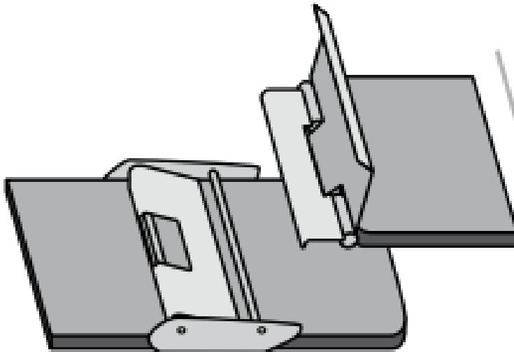
1) Placer la partie avec le crocheton au dessus de l'autre.
