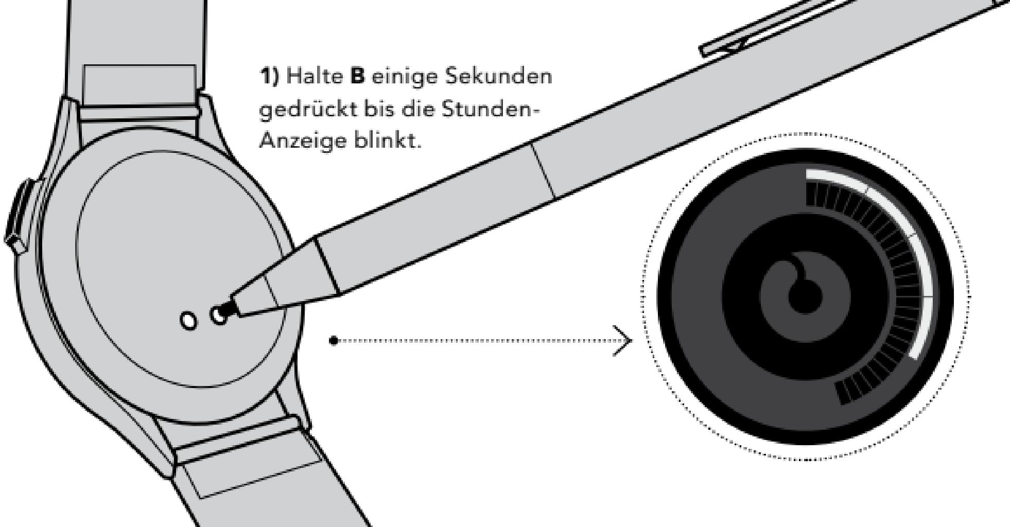
1) Halte **B** einige Sekunden gedrückt bis die Stunden-Anzeige blinkt.
