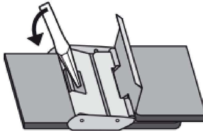
**2** Klappe mit einem kleinen Werkzeug wie z.B. einem Schraubenzieher gemäß Abbildung aufheben.
