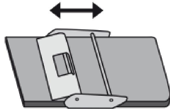
**3** Déplacer la boucle jusqu'à la position souhaitée. Fermer et appuyer sur la barre pour bloquer la boucle.
